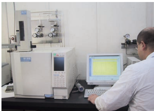
ガスクロマトグラフ質量分析機器 空気中の揮発性物質をごく微量であっても抽出して濃度を分析することができます。
